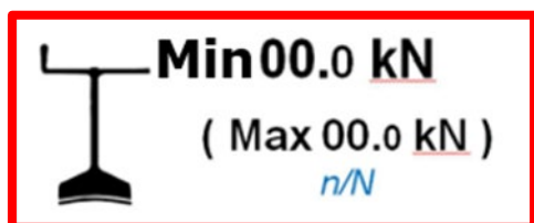
Figure 3 : Marquage de la force du frein de stationnement
